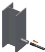
Svetsbar hylsa för anslutning till stålkonstruktioner
